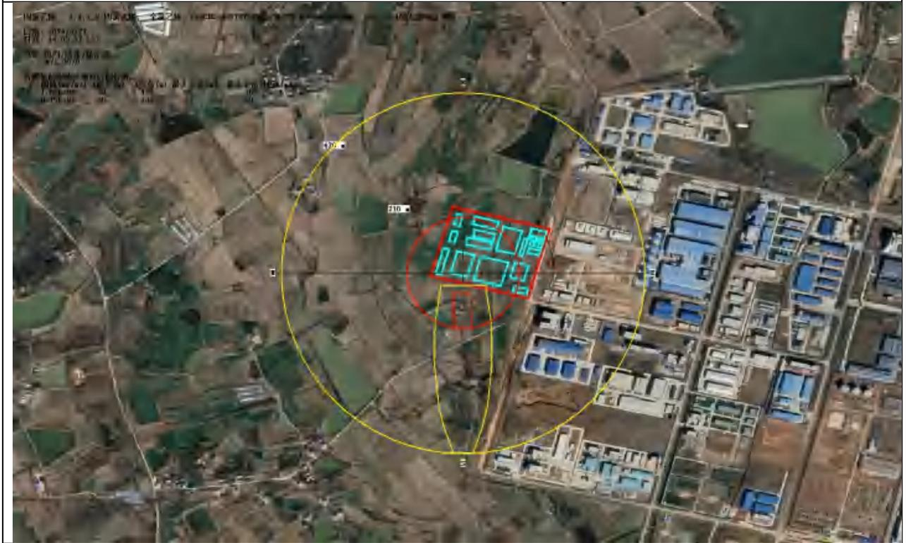
四氯乙烯最常见气象轴线超过阈值最大轮廓线
