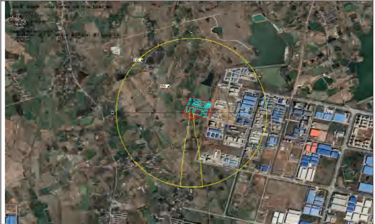
SO<sub>2</sub> 最常见气象轴线超过阈值最大轮廓线
