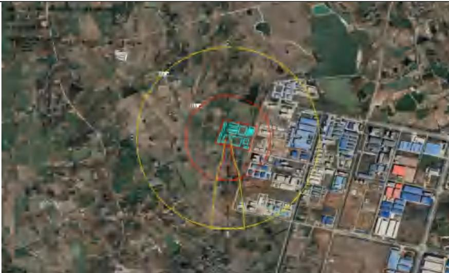
硝酸最不利气象轴线超过阈值最大轮廓线
