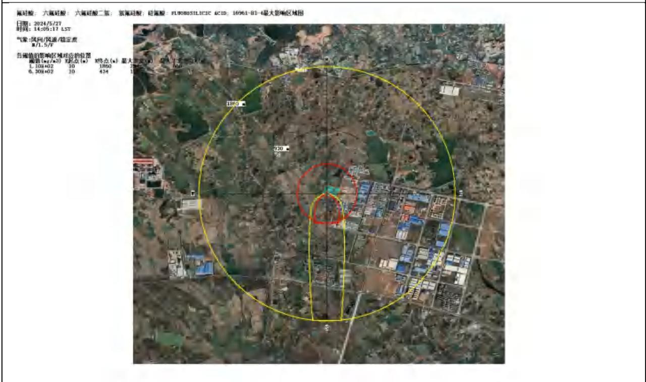
氟硅酸最不利气象轴线超过阈值最大轮廓线
